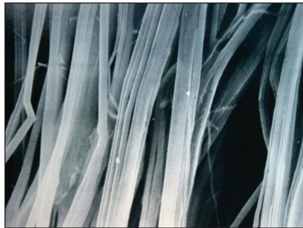
**Fig. 17.** Comparaison avec la membrane non résorbable Gore-Tex®. Fort grossissement des faisceaux de fibres de téflon.
